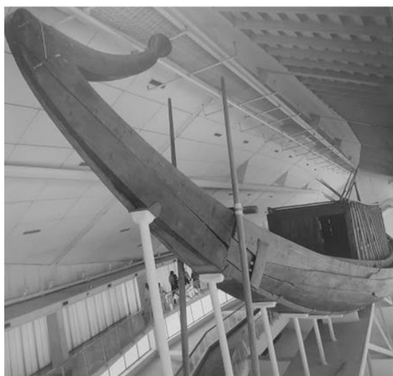
Fig.05 Embarcação Egípcia de 43 metros de comprimento que tem mais de 4000 anos. Foi encontrada em 1954 próxima a pirâmide de Quéops. Suas 1224 peças soltas foram encontradas ordenadas e em bom estado o que possibilitou a uma equipe de pesquisadores, após estudos sobre sua forma de construção, remontar a estrutura do Barco que hoje encontra-se em exposição no Museu do Barco Solar, perto das Grandes Pirâmides de Gizé. Foto: Eberhard Thiem, Kaufbeurenque (2006).
